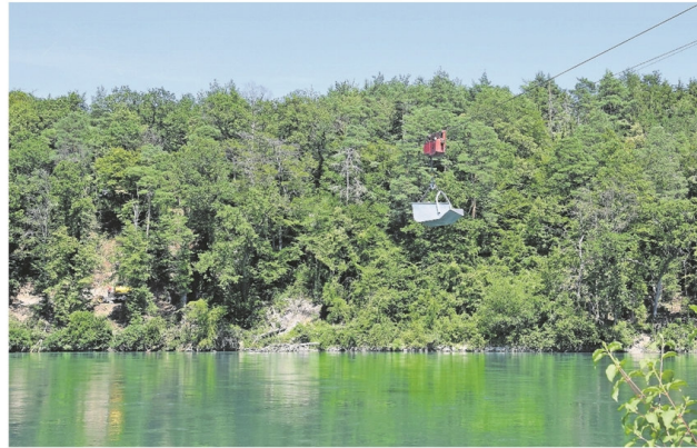
Rund ein Kubikmeter Material kann pro Fahrt über die Aare transportiert werden, die an dieser Stelle über 100 Meter breit ist.
